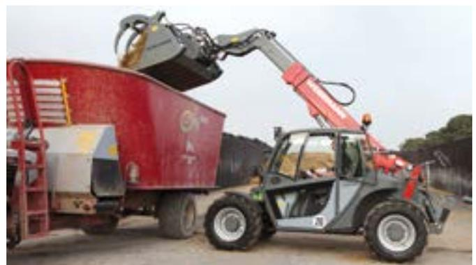
Neben neuen Rad- und Teleskopladern in der 6- und 7-Tonnen-Klasse sowie einem kleinen Teleskoplader mit 4,15 m Hubhöhe präsentiert Weidemann den Teleskoplader **T 5522** mit einer Bauhöhe von 195 cm, einer Nutzlast von 2,2 t und einer Hubhöhe von 5,5 m.
