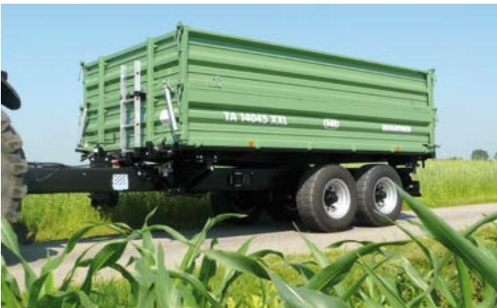
maße: 4,48 x 2,15/2,25 m konisch, selbstreinigender Stahlblechboden aus 5 mm Stahlblech aus einem Stück (Foliennahtverschmelzung), Pendelbordwände seitlich und hinten, Bordwände 600 mm, Aufsatzwände 600 mm. 2-Leiter-DL-Bremsanlage, Kartoffelschieber hinten und vieles mehr. Ein tauchgrundierter Fahrgestellrahmen sowie tauchgrundierte Bord- und Aufsatzwände mit ACC Oberflächentechnik machen den TA 14045 XXL zu einem wahren Universalfahrzeug.
