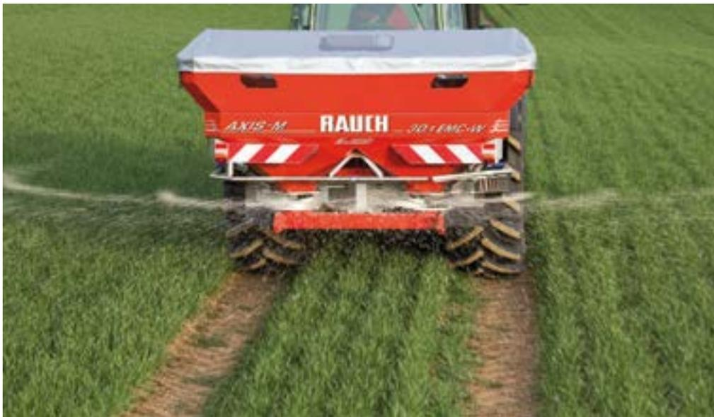
Rauch setzt erstmalig für Axis mit mechanischem Antrieb die elektronische Massenstromkontrolle und -regelung „EMC“ ein. Die Ausbringmenge wird dabei
