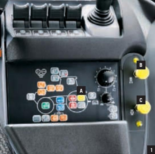
**1** Zapfwellensteuerung in der Kabine des Profi und Profi CVT
