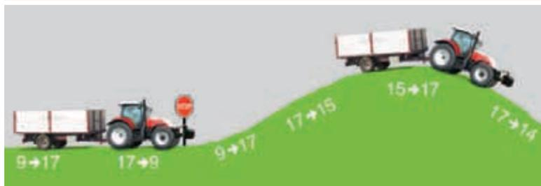
**17 x 16 GETRIEBE FÜR 50 KM/H ODER 40 KM/H ECO-GETRIEBE.** Das 4-fach Powershift ist mit einem 17. Vorwärtsgang erhältlich, der mit einem kraftsparenden direkten Durchtrieb im Getriebe bis zu 50 km/h auf der Straße erlaubt. Alternativ kann die eco-Version für kraftstoffsparende und immer noch flotte 40 km/h gewählt werden.
