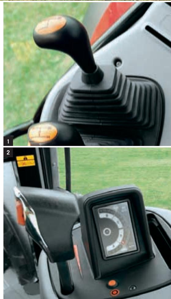
**1** Gute Auswahl an Getrieben. 2-stufiges Powershift mit 24 x 24 Gängen in drei Geschwindigkeitsbereichen oder ...
