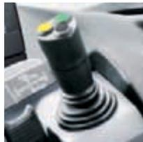
werden kann, weist auf diese Zielstellung hin. Der Kreuzschalthebel für den SZ Lader ist ergonomisch in die Bedienelemente integriert. Alle erforderlichen Kupplungen sind werkseitig montiert und die Hydraulikleitungen auf kürzeste Wege ausgelegt, um einen harmonisch weichen Betrieb des Laders zu gewährleisten.
