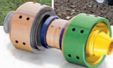
**STUFENLOSE STEUERUNG** des Übersetzungsverhältnisses durch die hydrostatischen Einheiten.
